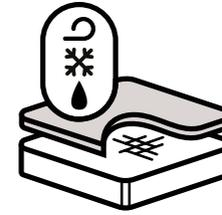
Pénétration d'électrolyte Les molécules d'eau pénètrent dans le revêtement à divers degrés en fonction du TOW et de la matrice de finition de surface. Lorsque la membrane de revêtement respire pendant les changements climatiques, elle provoque une exposition à l'eau (électrolyte) au métal prétraité. Si le prétraitement est correct, les cellules de corrosion ne se formeront pas.
